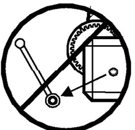
**3.16** - NUNCA desmontar la manivela del cabestrante cuando el elevador está soportando una carga o extendido.
