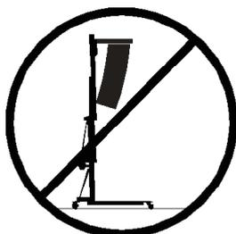
**3.4** - Este elevador NUNCA debe utilizarse para elevar una carga que no ha sido correctamente revisada. Es necesario verificar que la carga está correctamente apoyada y centrada en el soporte de elevación apropiado para que el peso de la carga sólo actúe en una dirección vertical.
