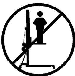
**3.1** - La torre elevadora TE-074 es una máquina diseñada para la elevación de cargas en dirección vertical. NUNCA se debe utilizar como plataforma elevadora de personas.
